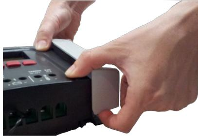
Abb. 3: Abdeckung aus der Endstellung lösen (hier: rechte Abdeckung)
